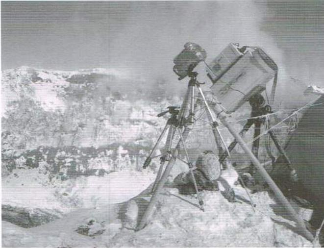
Figura 10. A máquina fotográfica térmica de Clive Oppenheimer e equipamento de medição de gás a espreitar para dentro da cratera.
