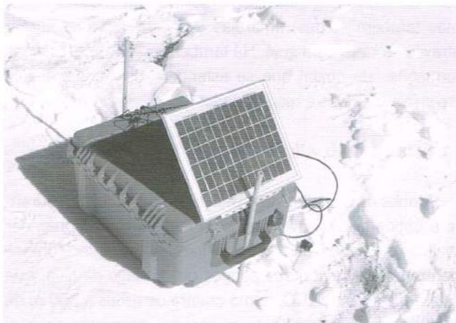
Figura 7. Uma das estações de sismógrafos. O painel solar mantém a bateria carregada para que as medidas possam ser tiradas por um período mais longo.
